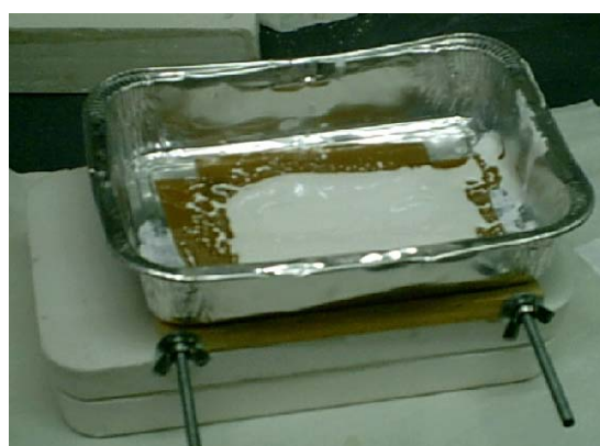
Fig. 5 – Slip casting di una piastra
