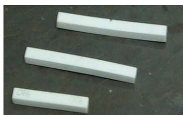
Fig. 7 – Distorsioni nei provini
