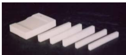
Fig. 6 – Sequenza di lavorazione per taglio e rettifica
