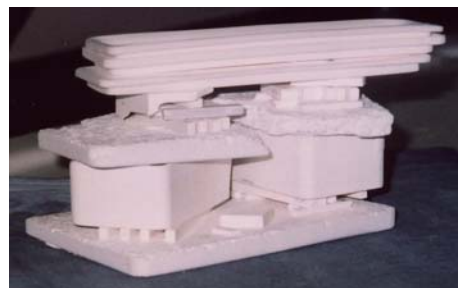
Fig. 8 – Piastre per limitare le distorsioni in fase di sinterizzazione
