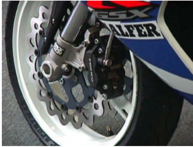
Fig. 12 disco in composito per motocicletta
